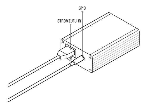
Schaltstrom Input: 230~V, 24V oder 12V
